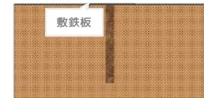
必要に応じて改良材を混ぜ、表層の地盤改良を行う。
