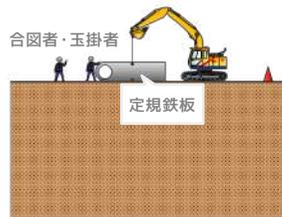
定規鉄板を削孔位置に合わせてセットする。
